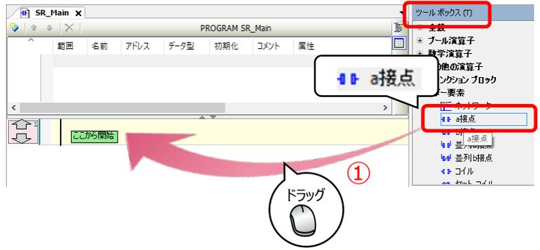
② 配置した[a接点]の[???]に[GVL.SW00]と入力します。
