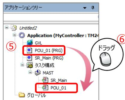
⑥プログラム作成後は、作成したPOUをタスクにドラッグ & ドロップで移動します。
