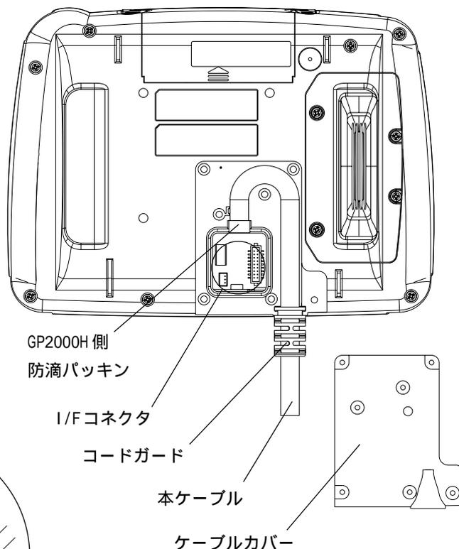
本ケーブルを溝にあわせて曲げ、コードガードを GP2000H に取り付けます。
