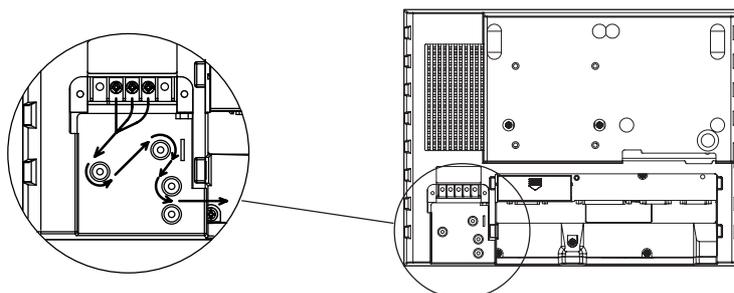
電源端子台に電源カバーをかぶせ、電源カバー取り付けネジで取り付けます。適正しめつけトルクは0.5 ~ 0.6N・mです。
