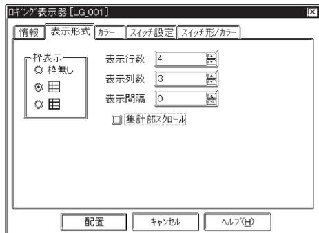
**MEMO** ・本例ではループ動作無しの場合です。ループ動作有りの場合は、集計部スクロールの設定は「無し」固定となります。従って、集計を表示される場合はスクロール表示に関係なく、画面上に常に集計部が表示されます。**参照** 「オペレーションマニュアル/2.1.17 ログ表示器」
