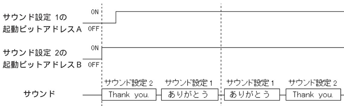
サウンド出力の各モードで複数の起動ビットが同時にONした場合、サウンド出力の順番はサウンド設定の設定順に行われます。
