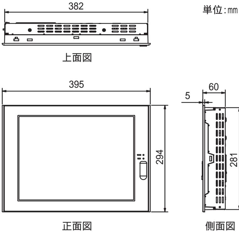
PS-Aに取り付け金具を装着した場合の外観図と各部の寸法図を示します。
