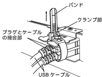
USB ケーブル抜け防止クランプの取り外し
