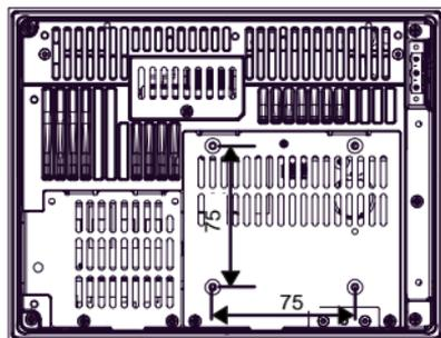
VESA 75mm 仕様のアーム取り付け穴です。M4 (長さ 6mm 以下) のネジで固定します。締め付けトルクは 0.7 ~ 0.8N・m です。
