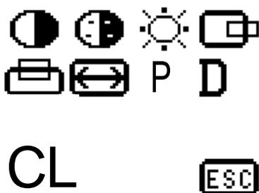
左図はOSDのメインメニューです。表示画面のキャラクタをタッチすることで下記の画面調整モードに移行します。ESCキーをタッチすることでOSDモードを終了します。
