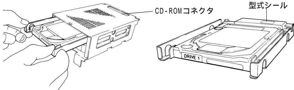
**重要** ・ ミラーディスクユニットのCD-ROM コネクタ部を上部とした場合、HDDの挿入方向は、型式シールが貼付してある面が上部となります。挿入時は上下の確認を必ず行ってください。
