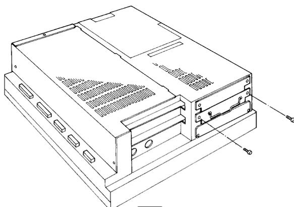
HDDユニットのネジ(2カ所)を外し、ブランクパネルを取り外します。
