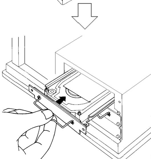
HDDユニットの取手を持ち、新たに組み込むHDDユニットをガイドレールに沿うようにPLに挿入し、コネクタが完全に接続されるよう差し込みます。
