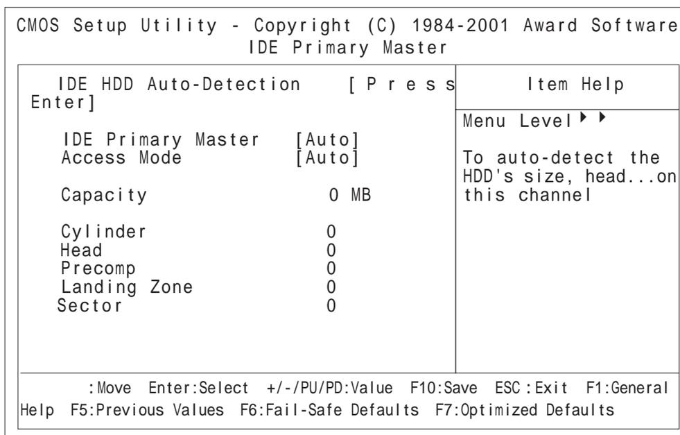
IDE Primary Master に [ Auto ] が選択されているか確認してください。[ Auto ] が選択されていますと起動時にディスクのパラメータを読み取って自動的に設定されます。[ Auto ] が選択されていない場合は、[ Auto ] を選択してください。出荷時の設定は [ Auto ] です。通常、出荷時の設定でご使用ください。(ハードディスクと併用の場合。)
