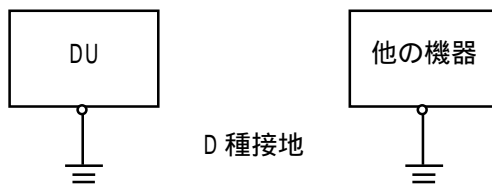
(a) 専用接地 最良
