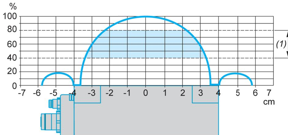
(1) 移動タグの場合、アンテナとタグの距離は40%～80%の間を推奨します。
