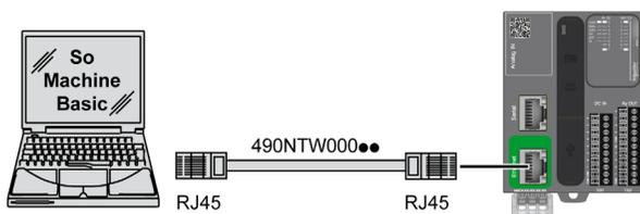
コントローラーとコンピューターを接続する手順を以下に示します。
