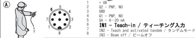
Teach-in Anti-Collision Mode through external wire / 外部接続からの衝突防止モードのティーチング
