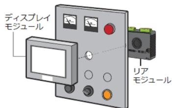
丸穴だけで盤取付けできるから、後付け簡単
