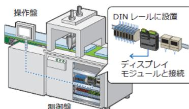
操作盤と制御盤を離して設置でき、設備のレイアウトがしやすい
