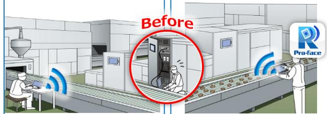
デバッグ作業に盤開閉は不要。PCと盤内のPLCとのアクセスを無線でできます。
