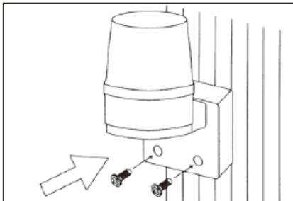
③ プレート部に本体をひっかけるようにして取り付け、最後にネジを締め付けて設置完了。
