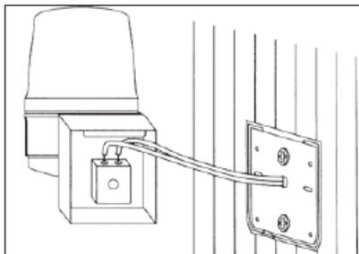
② 次に、配線を本体に備えられたコネクタに差し込み、結線します。露出配線の場合は、ベースの下側面からコードを引き込みます。
