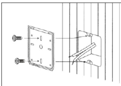
① 壁面または、スイッチボックスに、パッキン付きプレートを手で押し付け、ネジを締め付けます。
