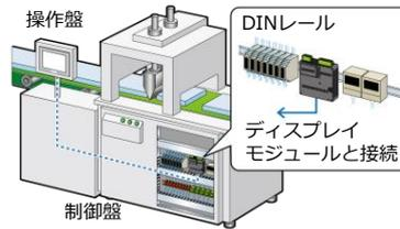
操作盤と制御盤を話して設置でき、設備のレイアウトがしやすい
