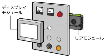
丸穴だけで盤取付できるから、後付け簡単
