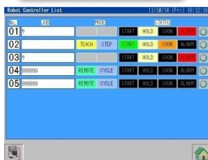
各コントローラの状態表示
