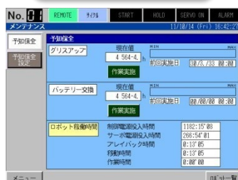
グリスアップ、電池交換時期管理、電源等投入時間を表示
