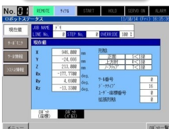
ロボット/サーボの現在値、ツール情報、システム情報を表示
