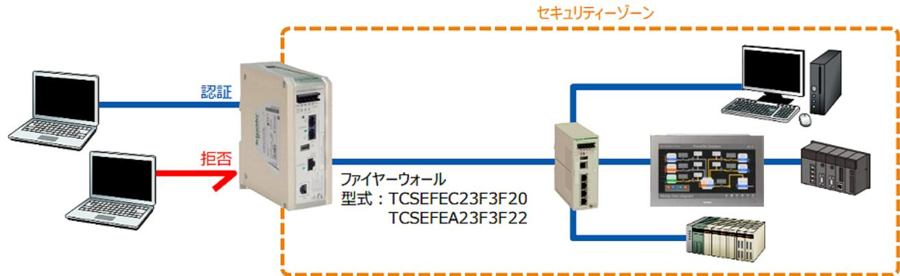
設定したセキュリティのルールに基づいて各機器、およびネットワーク間の通信を制限でき、システムとして認証されていないデバイスやトラフィックデータから制御システムを保護します。
