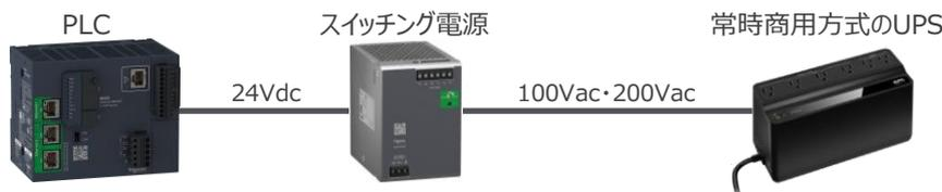
常時商用方式の運転方式は、10msecほど切替時間が発生するため、電圧が不安定な場所での使用には適しておりません。
