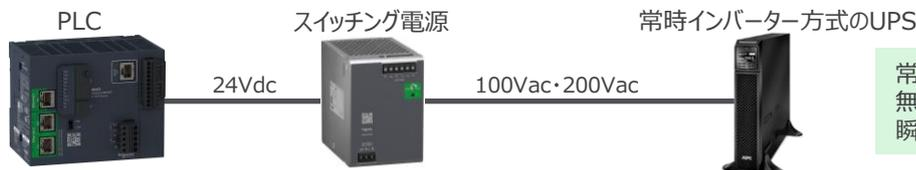
常時インバーター方式は、切替時間がなく無瞬断でバッテリー運転に切り替わるため、瞬停対策にも適しています。
