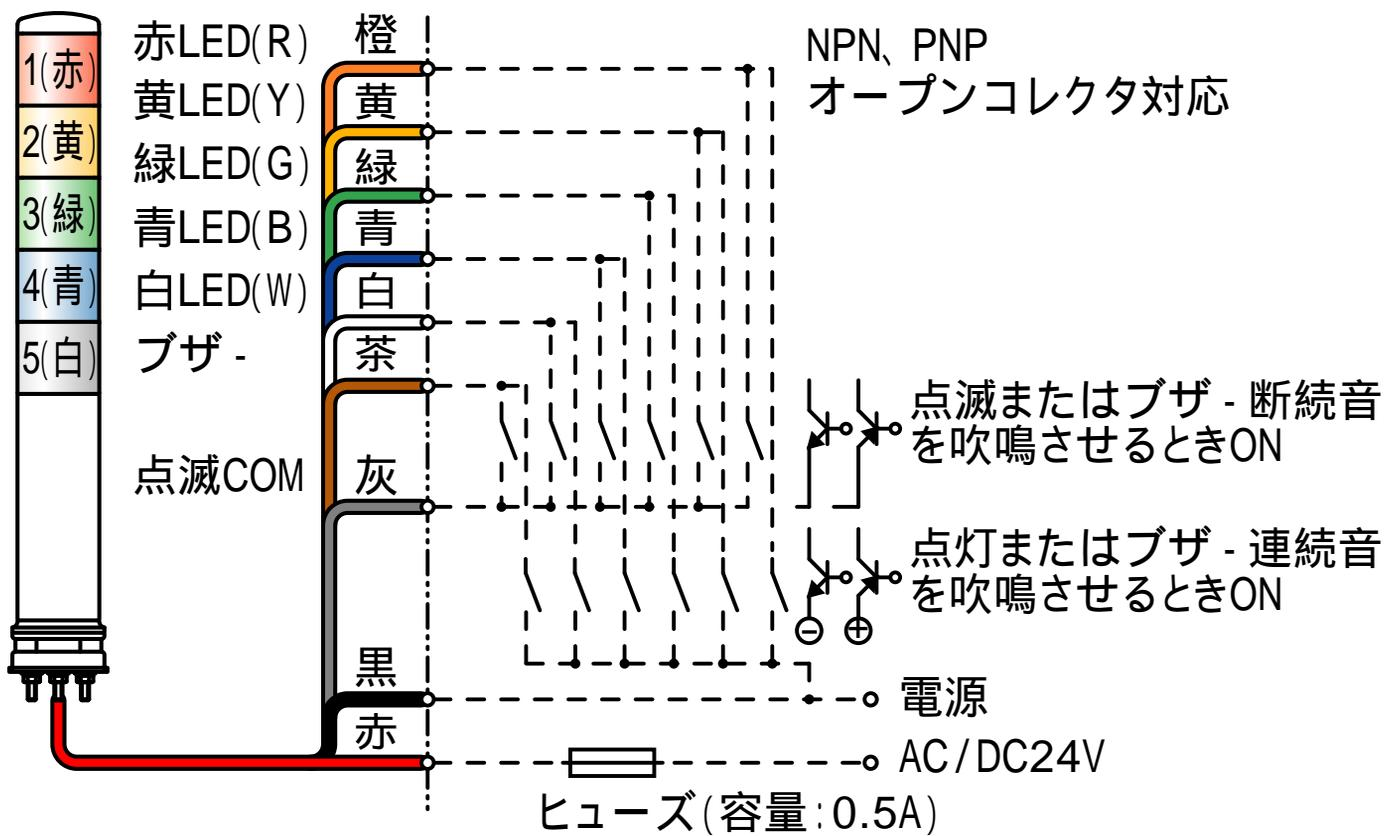
上記結線例では、点灯・点滅または、ブザー連続音・断続音を同時入力の場合、点灯または連続音が優先し、他の段の点滅またはブザー断続音の吹鳴ができなくなります。
