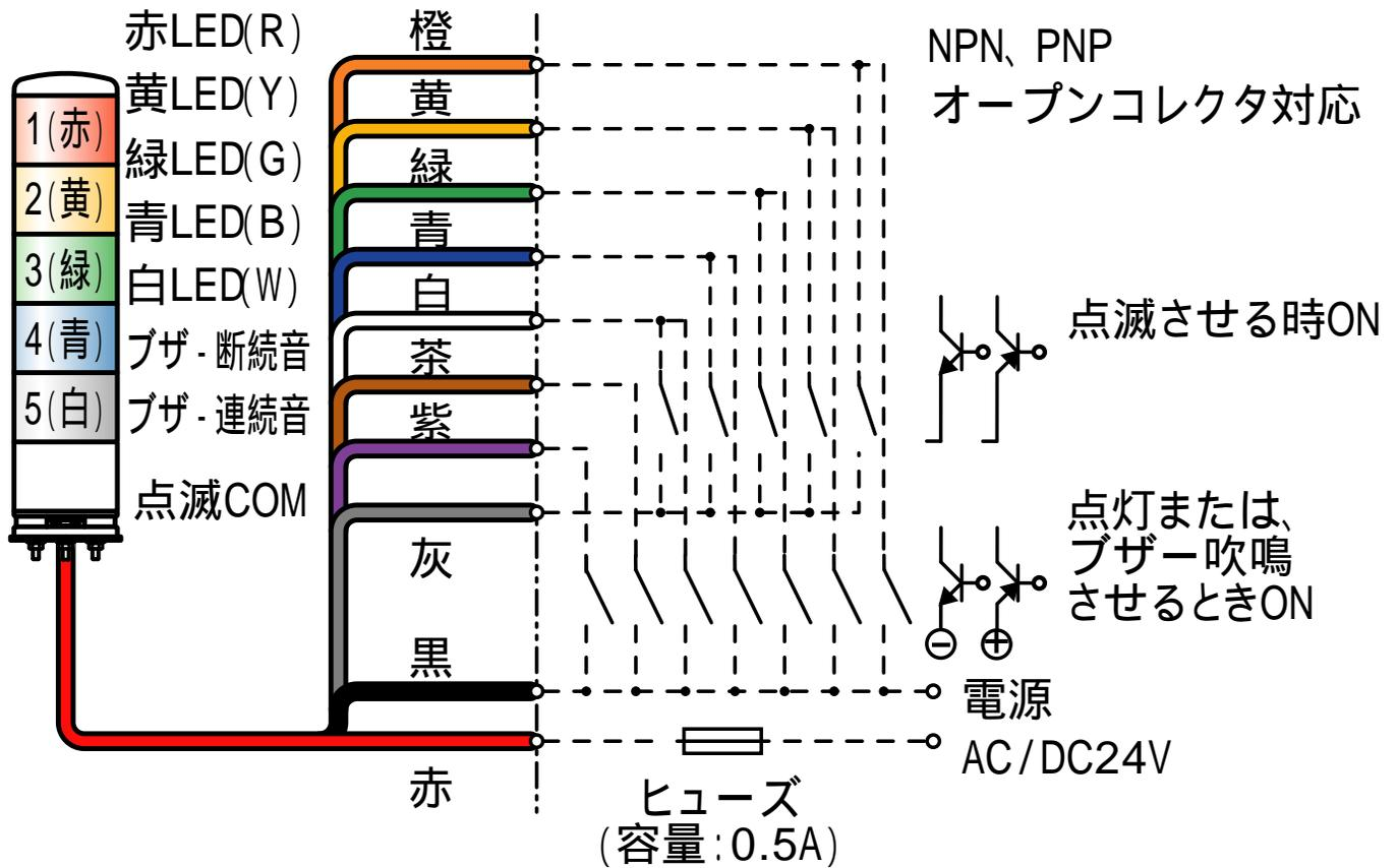
上記結線例では、点灯・点滅同時入力の場合、点灯が優先し、他の段も点滅できなくなります。また、ブザー連続音・断続音を同時入力の場合、連続音が優先します。
