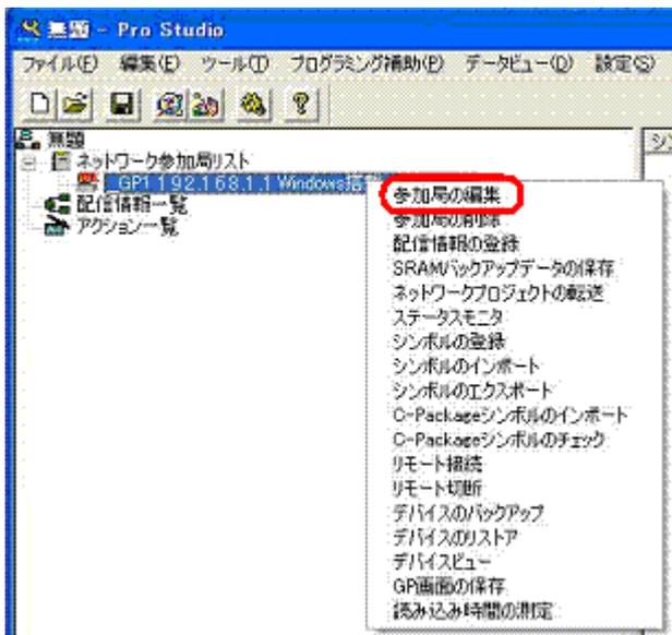
2.6 [参加局の編集]ダイアログが表示されます。[PLCタイプ]をプルダウンメニューの中から、[PLPSA,PSBシリーズ]を選択し、設定します。
