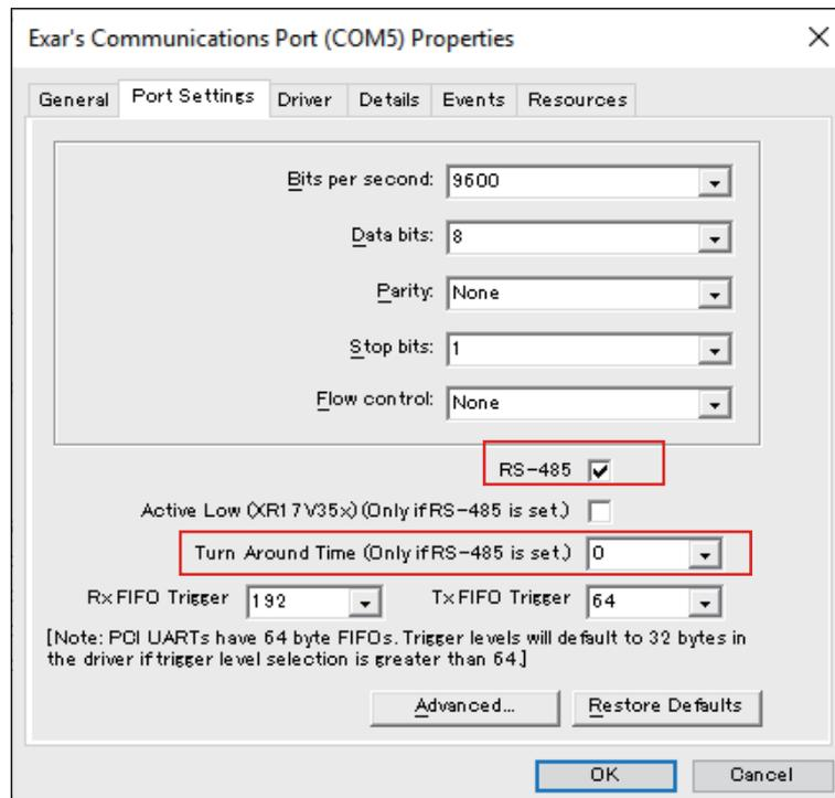
6. **Turn Around Time** 指定了从通信数据传输完成到系统变为可接收通信数据状态的时间长度 (数据位时间)。经过指定的时间后，系统将处于接收数据的状态。如果在需要考虑传播延迟的长距离通讯环境中使用，请设置数据位时间。缺省值是 0。
