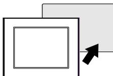
3. 确认面板类型顶部的防坠锁已抵住面板。
