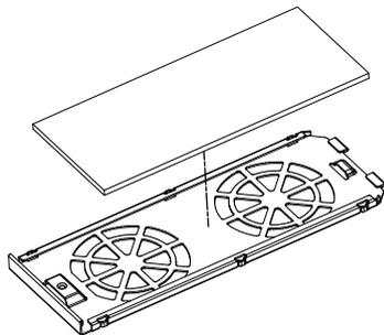
6. 重新插入风扇过滤器托盘并拧紧螺钉。
