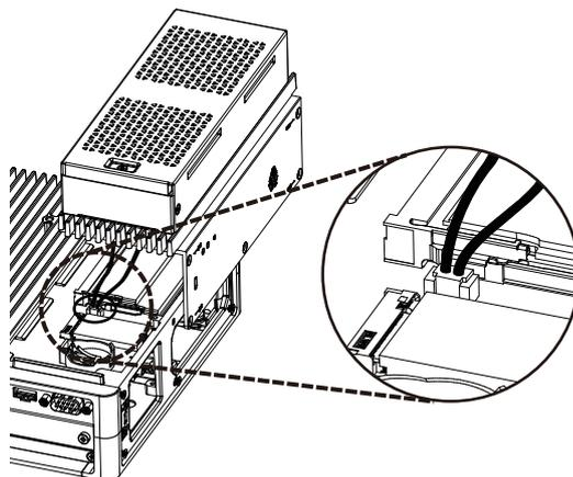
6. 使用步骤3中卸下的螺钉，固定风扇套件。
