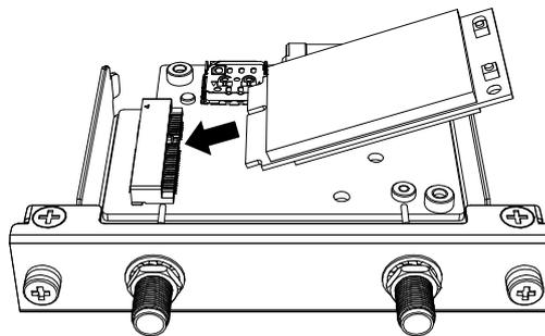
3. 从上方压住 4G mini PCIe 卡，并使用在步骤 1 中卸下的螺钉将其固定。
