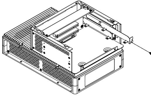
6. 插入PCI/PCIe卡，并用步骤5中卸下的螺钉将卡固定。
