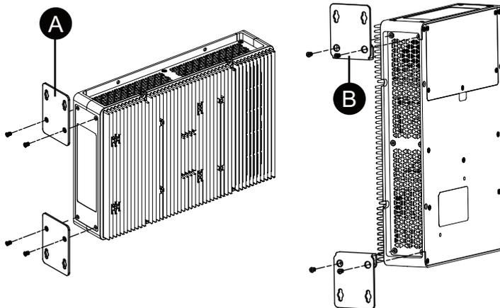
3. 用M4螺钉 (4个) 将产品安装到面板或墙壁上。
