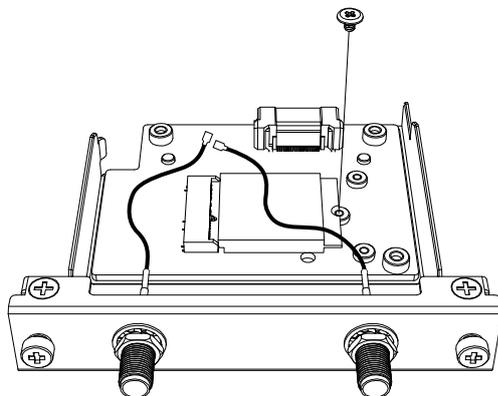
4. 如下图所示，将天线电缆连接器牢固插入卡上的连接器。从接口上方看，将左侧电缆连接器插入连接器1，将右侧电缆连接器插入连接器2。
