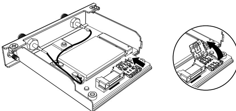
6. 将 SIM 卡插入插槽。
