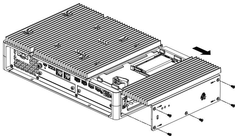
4. 如果配有M.2 SSD，请在安装风扇套件之前卸下散热器和散热器垫（顶部）。有关M.2 SSD的散热器和散热器垫的信息，请参阅 [M.2 SSD 安装](#)。
