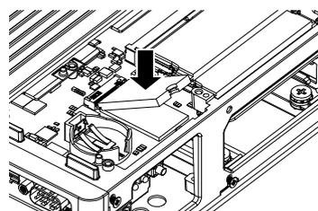
7. 用步骤5中卸下的螺钉固定M.2 SSD卡。
