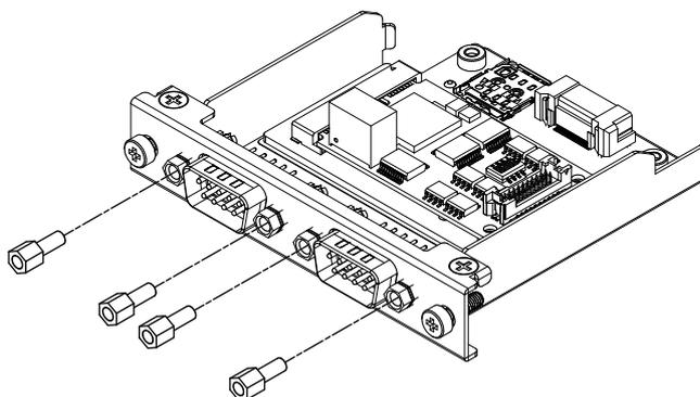
2. 断开接口连接器与接口盒的连接，同时断开与板连接的电缆。
