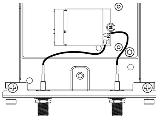
5. 将此接口连接到产品。仅在将产品安装到面板上后才连接天线。
