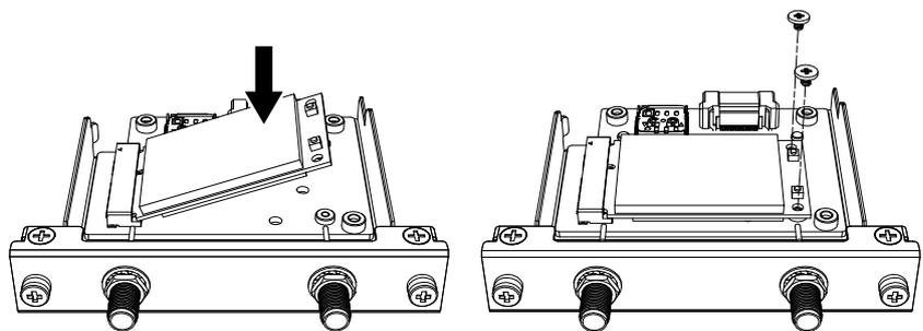
4. 如下图所示，将天线电缆连接器牢固插入 4G mini PCIe 卡上的连接器。从接口上方看，将左侧电缆连接器插入连接器1，将右侧电缆连接器插入连接器2。
