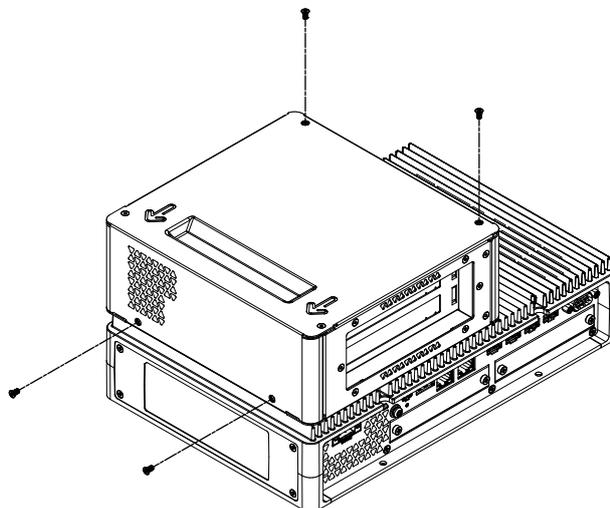
4. 按盖顶部的箭头方向滑动盖，然后将其拆下。
