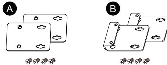
2. 卸下装到产品上的螺钉 (4 个), 然后使用书本安装适配器的螺钉将其固定到产品上。连接到产品顶部时, 请连接 B 书本安装适配器, 使突出部分面向产品。
